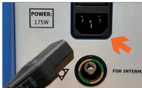
Figura 56 DISCONNESSIONE CAVO DI ALIMENTAZIONE
