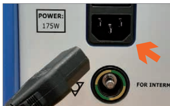
Figura 57 DISCONNESSIONE DEL CAVO EQUIPOTENZIALE
