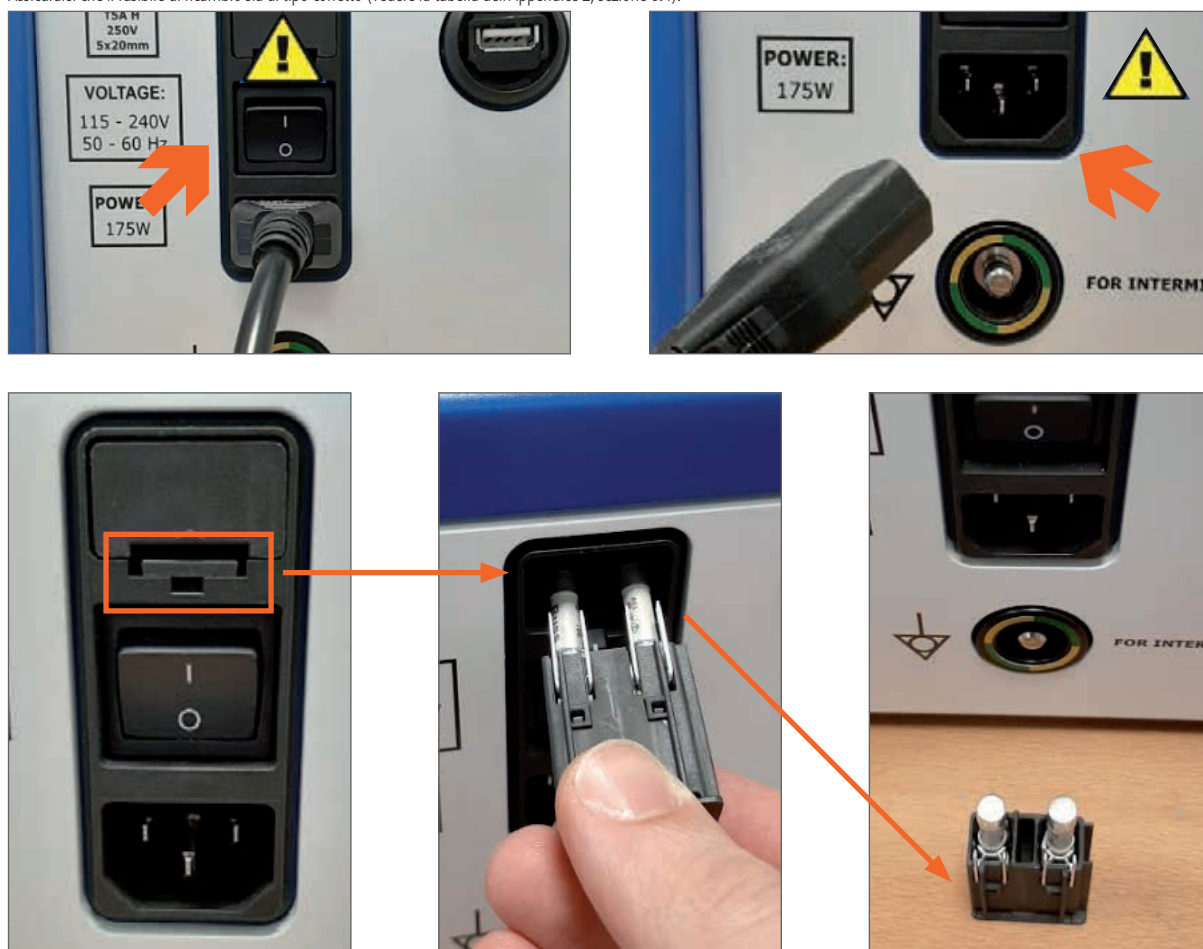
Figure 72 SOSTITUZIONE FUSIBILI PRINCIPALI
