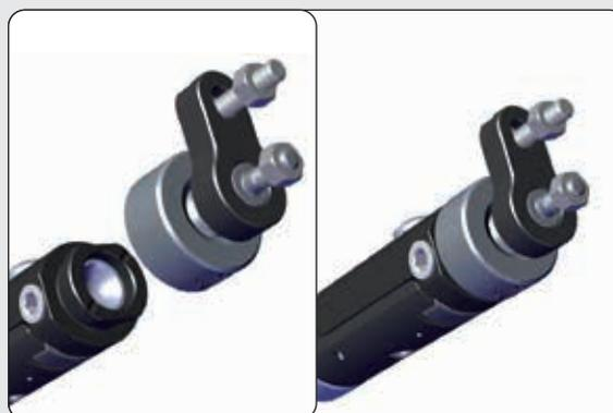
Applicando una leggera pressione, ruotare il collo di 90° per allineare la freccia al punto sulla camma. L'anello si chiude con un clic.
